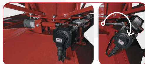
高品質で高精度のサーボインデクサーは、 最高速度での印刷時も スムーズで静かな動作環境を確保
