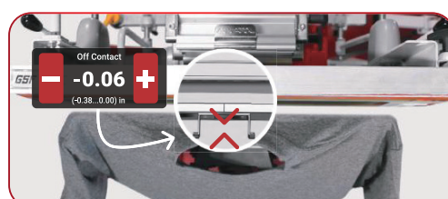
タッチスクリーンより オフコンタクト量を調整可能
